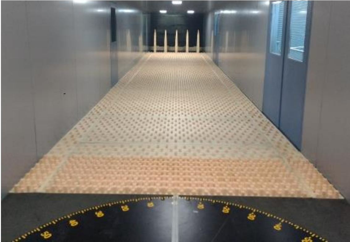
Fig. 4.3. Simulación de ABL urbana (CT4) con método de Counihan, escala 1:410.
