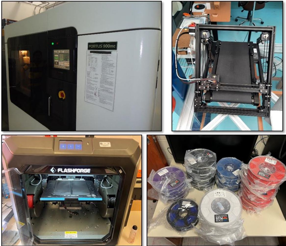
Figura 1 Algunos tipos de impresoras para MA, así como materiales de deposición.
