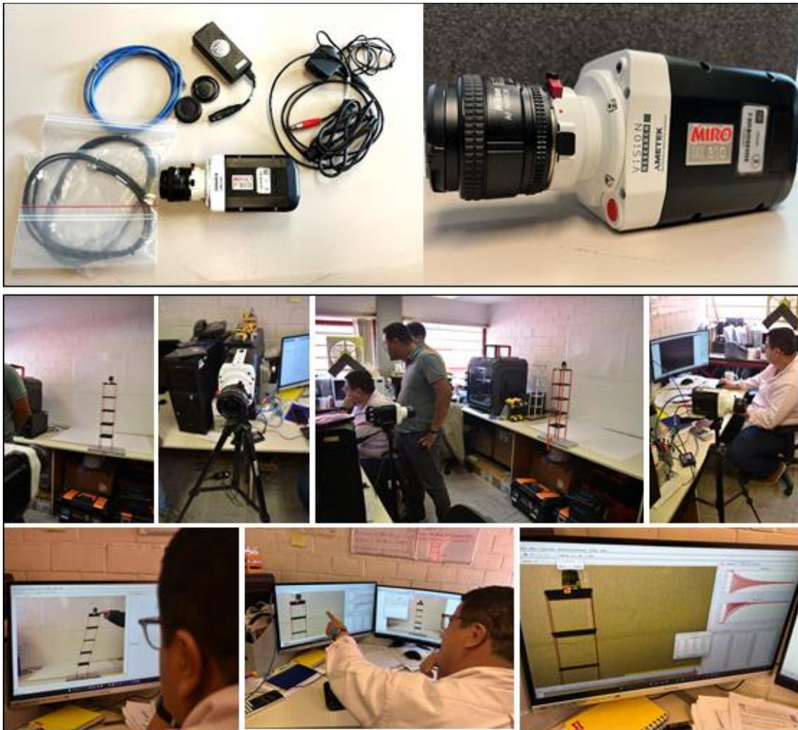
Figura 4 Cámara de alta velocidad Phantom empleada en las pruebas para evaluar las propiedades dinámicas de los modelos a escala (arriba) y la colocación de la cámara con respecto al modelo (abajo).
