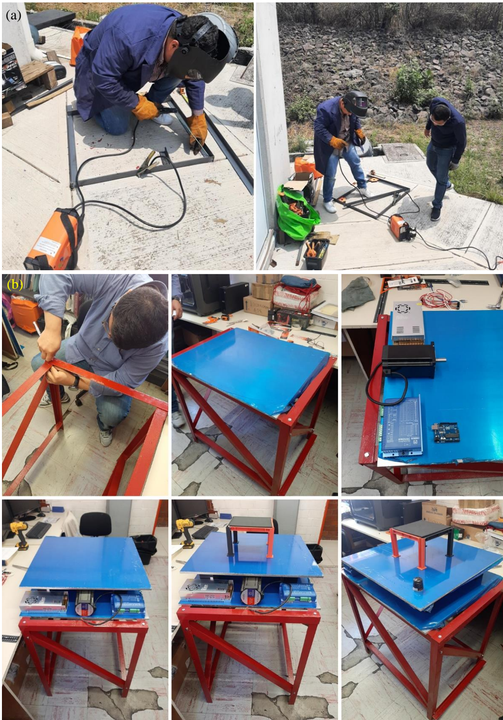
Figura 3. Construcción de la mesa vibradora estudiantil: (a) Mesa de soporte; (b) Elementos de la mesa vibradora.
